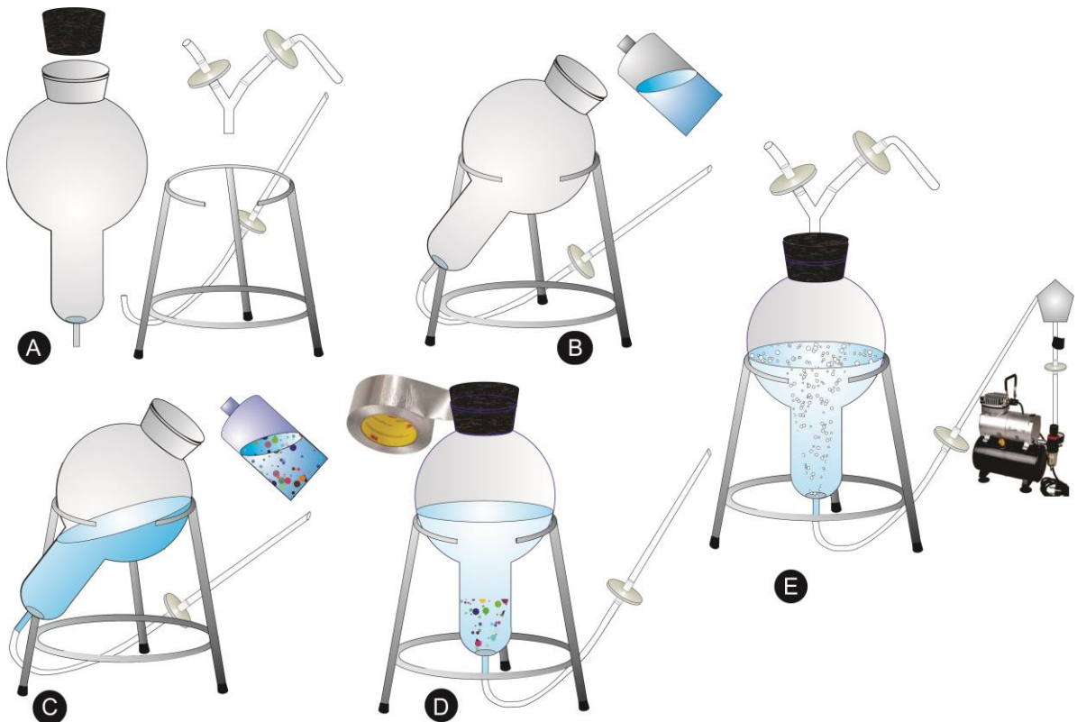
Hình 2.3. Thao tác trên hệ thống Bioreactor [16]. A. Lắp ráp các bộ phận và bọc nylon chịu nhiệt và hấp khử trùng; B. Đổ môi trường; C. Cấy mẫu; D. Dán kín miệng bình; E. Nối hệ thống vào máy bơm khí.
